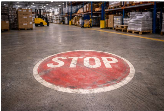
รูปสัญลักษณ์จากการทาสี เมื่อเวลาผ่านไปสักระยะจะเลือนราง ไม่ชัดเจน เนื่องจากเกิดการเสียดสี หลุดร่อน จากการทำงาน
